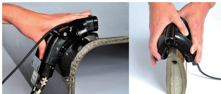
图6 WrapIt柔性阵列探头用于检测CFRP 构件不同曲率的R区
